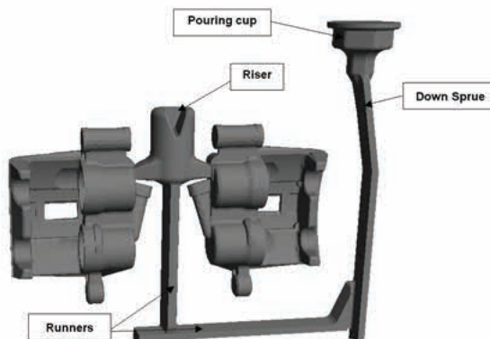
部品の製造に使用した鑄造方案
