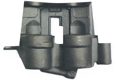
2 シリンダーのブレーキキャリパー (GGG-50-7) 画像提供: Azterlan 研究センター
